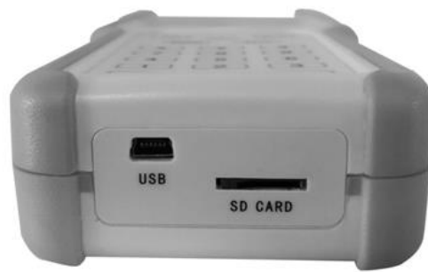
USB 充電/RS232 插口 SD CARD 資料邏輯儲存插槽(選購)
